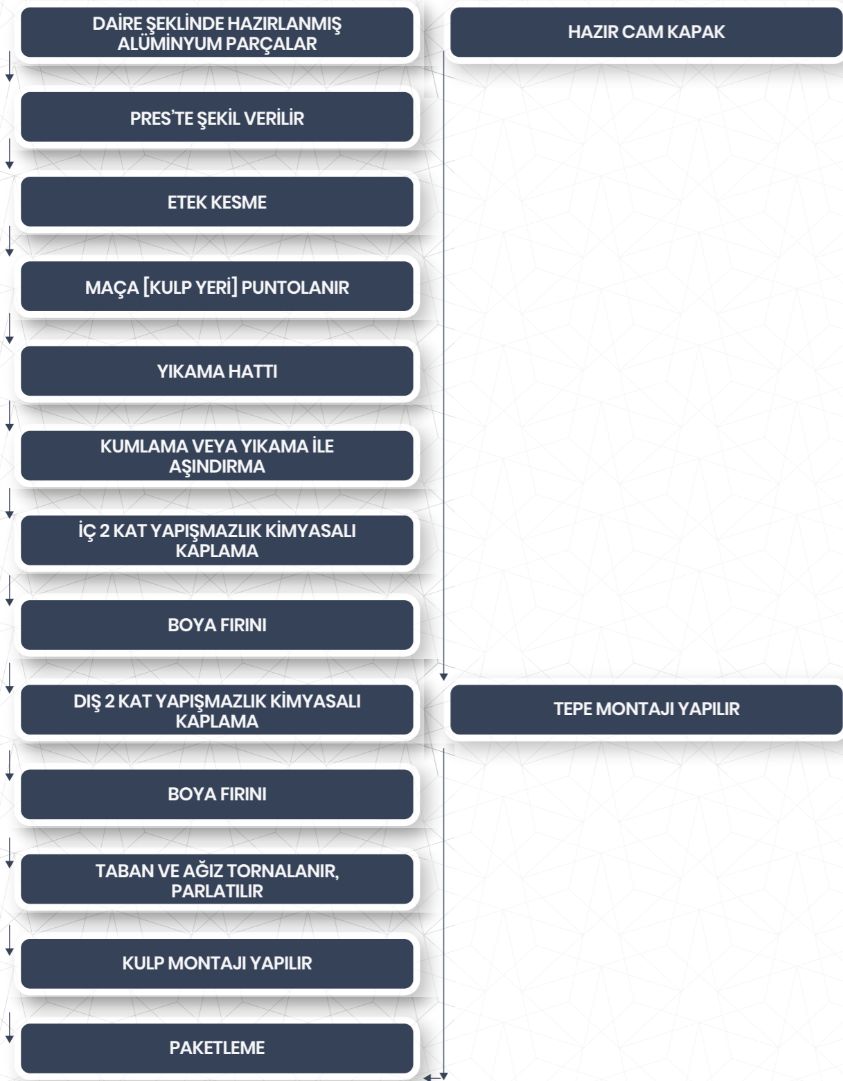
Şekil 20: Alüminyum Tencere İmalat İş Akış Şeması
