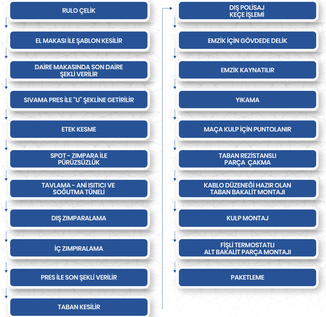
Şekil 22: Kettle Su Isıtıcı İmalatı İş Akış Şeması
