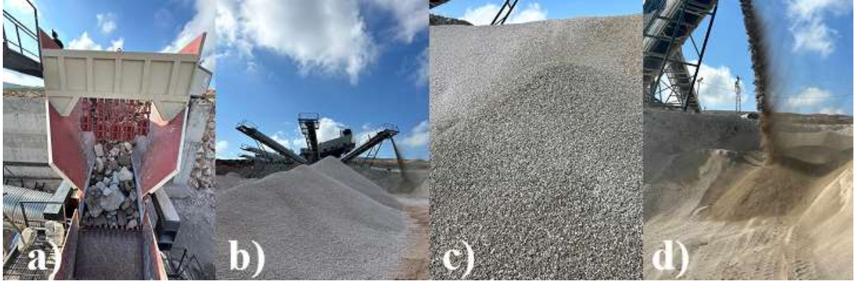
Şekil 5 Agrega kırma tesisi işlemleri a) kırıcının beslenmesi b) farklı boyutlara ayrılan BA’ların banttan giderek farklı bölgelerde yığın haline getirilmesi c) kırma işlemi sonrası BA Kaba agregası d) kırma işlemi sonrası BA İnce agregası
