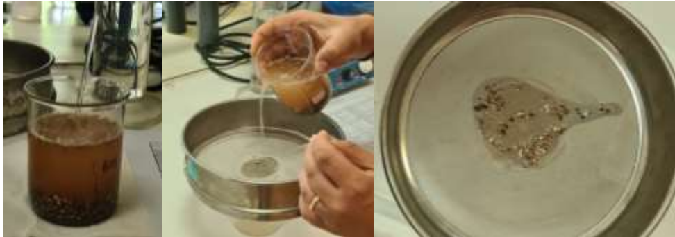
Şekil 14 Hafif tanelerin miktarı deneyi
